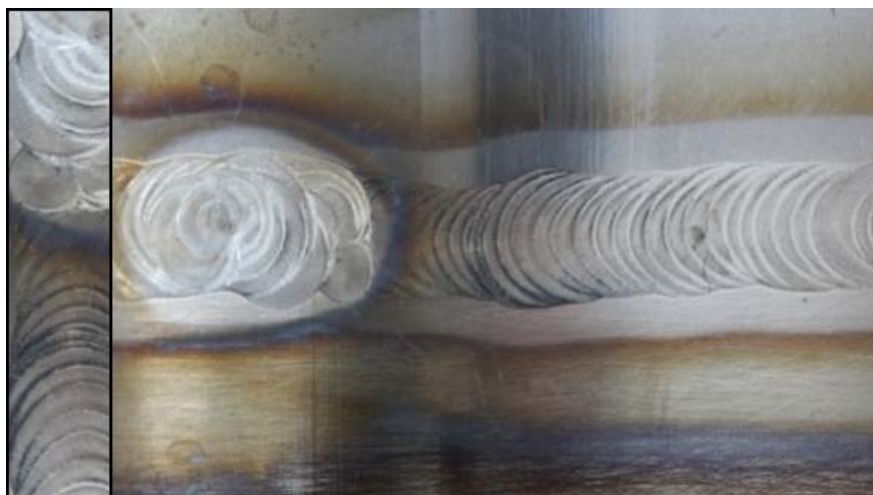
รูปภาพ 1 การเกิด Sensitization รอบ ๆ แนวเชื่อม
